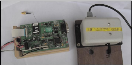
由数据采集仪、供电子系统、时钟 子系统及数据转换器等子系统构成
