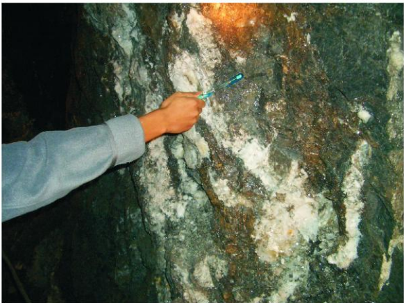
图 2 二里河铅锌矿床微石英岩与闪锌矿接触关系
