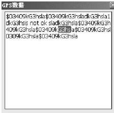
图 6 GPS 调试信息 Fig. 6 GPS NMEA Data
