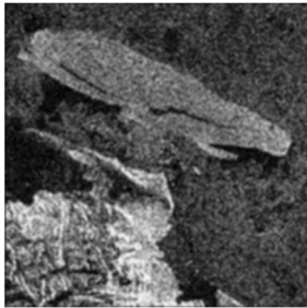
图 5 均值滤波 Fig. 5 Result of Average Value Filter
