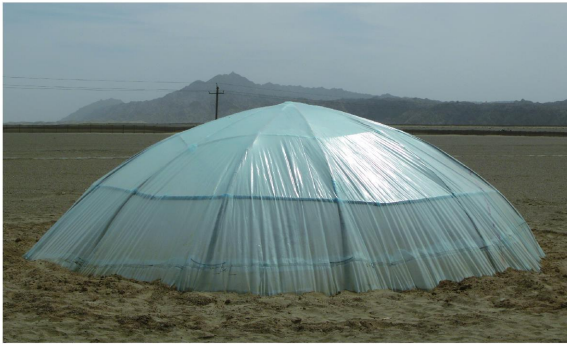
图 2 密闭塑料拱棚 Fig. 2 Airproof Plastic Greenhouse 内离地 50 cm 处的空气相对湿度、绝对湿度、温度, 在土壤中埋设 HOBO 监测仪监测 5、10、20、30、40、100 cm 土壤内空气的温湿度, 同时在棚外设立对照, 每 10 min 采集 1 次数据。在日尺度上分析土壤与大气水分的相互影响及土壤内部水分的活动规律。
