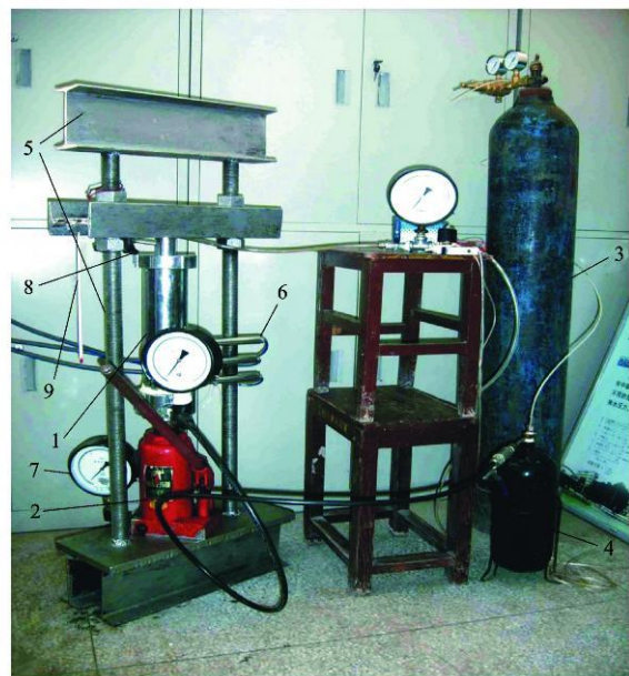
1—压力室; 2—千斤顶; 3—氮气罐; 4—水罐; 5—横梁; 6—孔隙水压力计; 7—千斤顶压力表; 8—百分表; 9—温度计
