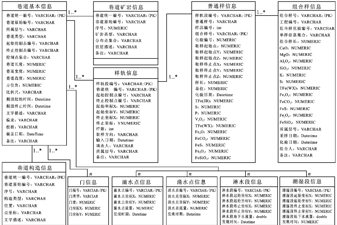
图 4 巷道地质素描图自动绘制的数据逻辑模型
