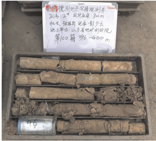
德州地面沉降观测井 2 号孔 396~400 m 深度处 图 2 现场岩芯钻孔地质编录
