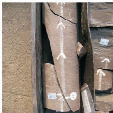
(c) 第 II 裂缝异常发育带(濮深18井4070.89 m 深度处),岩芯上发育多条高角度裂缝
