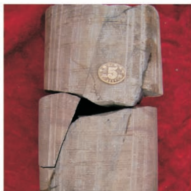
(a) 第 I 裂缝异常发育带(濮深12井3596.4 m 深度处),岩芯上发育两组共轭裂缝
