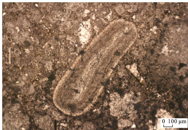
(d) 第16层成分复杂, 含枝管藻化石, 为泥晶灰岩
