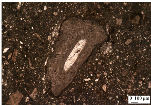
(e) 第17层成分较为复杂, 泥质支撑, 含生物碎屑(如枝管藻化石), 为泥灰岩
