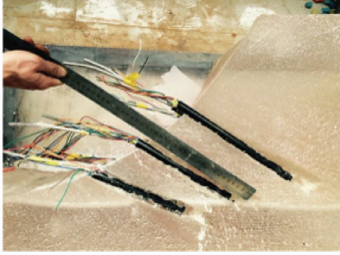
图 11 中层锚杆被拔出
