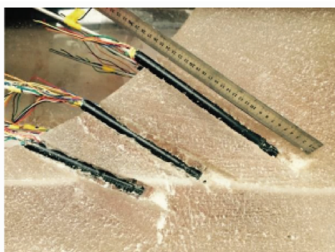
图 10 顶层锚杆被拔出
